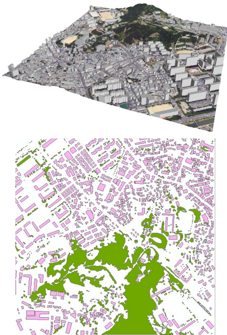
Fig. 2. LiDAR의 건물 및 식생 정보 추출 여기서 분홍색 폴리곤은 건물, 초록색 폴리곤은 식생지역을 의미
